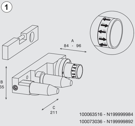
Preparar el hueco de la pared para el cuerpo interno según las cotas A,B y C. Instalen el mezclador como indicado en la figura antes de colocar las baldosas, pongan el sistema de seguridad cerrando el agua.
