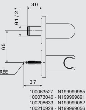
Instalen el soporte maneta con toma de agua, respetando las medidas del plano.
