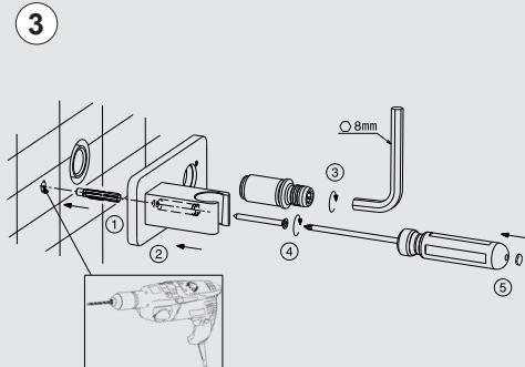
Perforar la pared en la posición marcada anteriormente. Introduzcan el taco (1) en lo agujero. Posicionar la plancha (2), atornillen el racor (3), el tornillo (4) y cubrirlo con la tapita (5).
