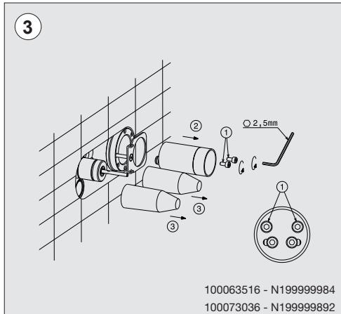
Desatornillen el tornillo de fijación (1) y quiten la protección (2) como indicado en la figura.
