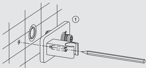
Apoyar la plancha (1) a la pared y marcar la posición de lo agujero para la sucesiva fijació de la plancha.
