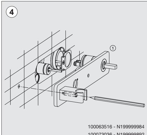
Apoyar la plancha (1) a la pared y marcar la posición de lo agujero para la sucesiva fijació de la plancha.
