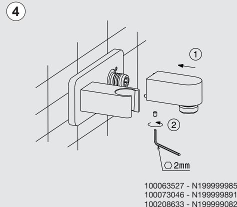
Montar las piezas exteriores según la secuencia indicada en el dibujo.
