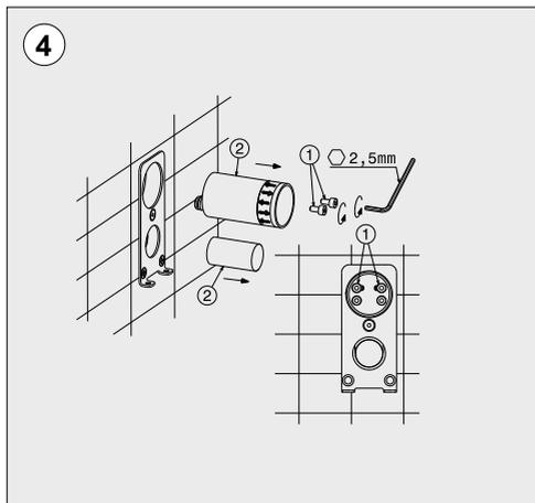
Desatornillen el tornillo de fijación (1) y quiten la protección (2) como indicado en la figura.
