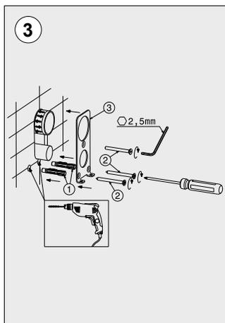
Perforar la pared en la posición marcada anteriormente e introduzcan los tacos (1); atornillen los tornillos (2) al cuerpo para empotrar interponiendo la plancha (3).
