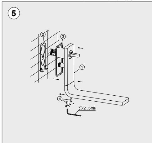
Sobrepongan el cuerpo del grifo (1) a la plancha (2) interponiendo la esponja (3); atornillen las clavijas de fijación (4) para asegurar el grifo.
