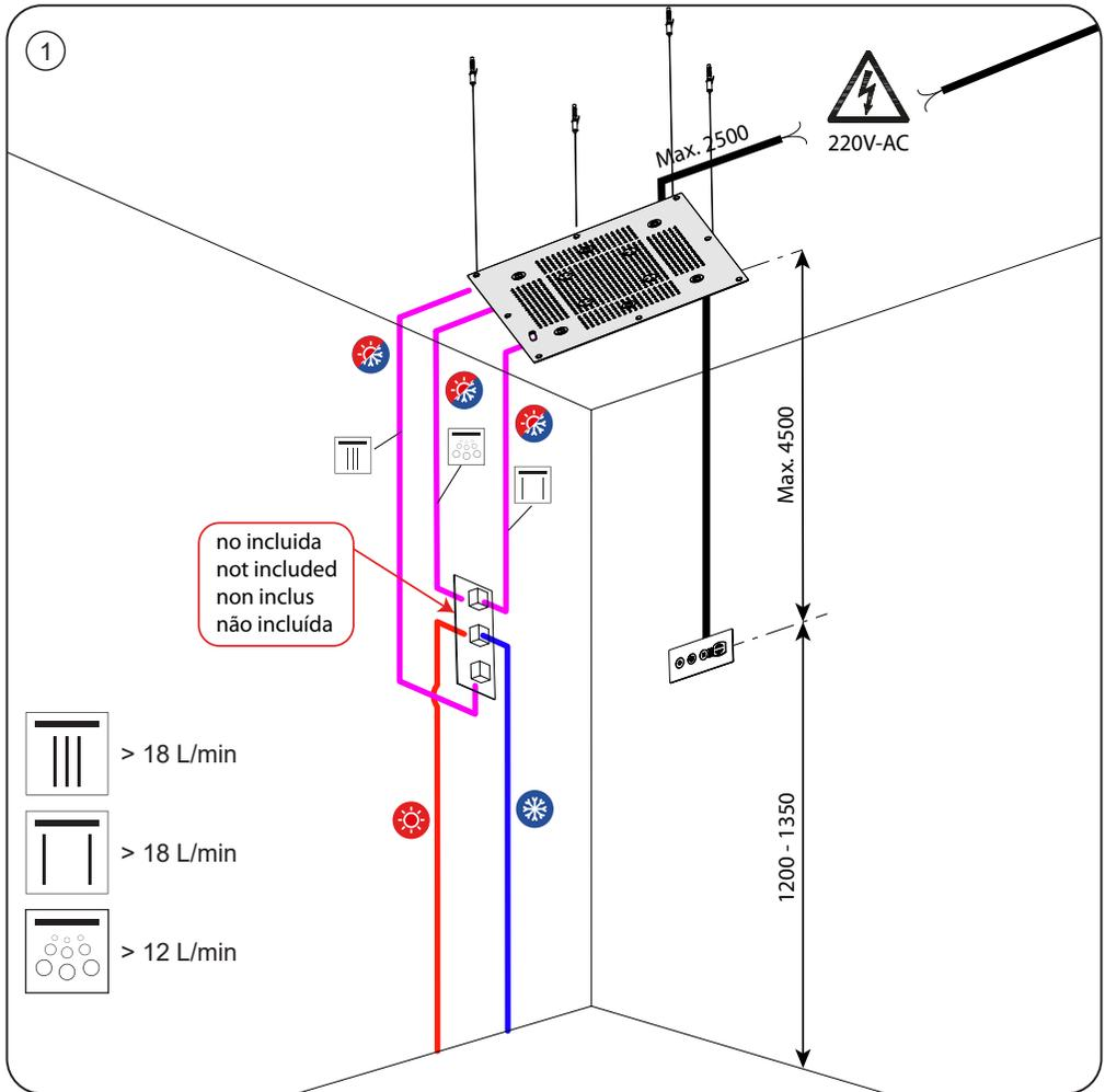
Es necesario una grifería de al menos 3 salidas que pueda usar simultáneamente 2 salidas para hacer funcionar el rociador. Estas 2 salidas simultaneas tienen que dar un caudal mínimo de 18 L/min cada una y se tienen que utilizar en la lluvia exterior y la lluvia interior.
