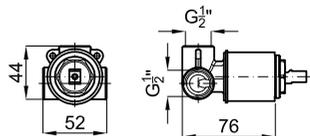
PROJECT LINE - Внутренняя часть встроенного смесителя для душа с керамическим картриджем 35мм и подключениями 1/2". Пропускная способность при 3х барах со смешанной водой 21л/мин
