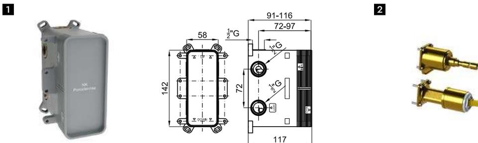
**1** SMART BOX - Универсальный встроенный корпус быстрой установки для смесителя с 2 или 3 выходами. С керамическим картриджем Ø35 мм и подключением 1/2". Пропускная способность всех трех выходов при давлении 3 бар составляет 20,1 л/мин. В комплект входят 2 глушителя шума и 2 заглушки 1/2". **100124167**
