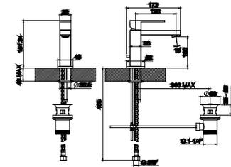
**1** Однорычажный смеситель для раковины, хромированный с керамический картриджем Ø25 мм. Связь 3/8", длина шлангов 405-мм, с автоматическим клапаном слива и аэратор "plus". Пропускная способность при 3 барах 10,5 л/мин.
