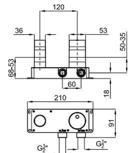
**1** Наружная часть встроенного смесителя для раковины. Без донного клапана. Напор при 3-х атмосфер 5 Л/мин
