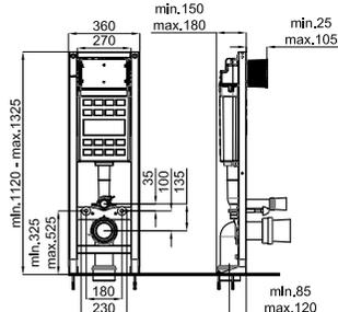
Каркас подвесного унитаза с бачком, самонесущий, шириной 35см. Включает комплект для крепления на стену и трубки для соединения с унитазом.
