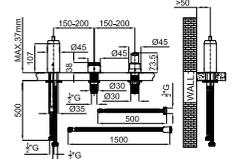
2A PROJECT LINE - Внутренний корпус смесителя, установка на ванне. Керамический картридж Noken Tri-Control Ø40 мм со встроенным переключателем.
