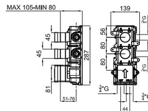
1 ОХО Наружная часть термостатического смесителя на 2 выхода. Нуждается во внутренней части на 2 выхода 100282740 ОХО
