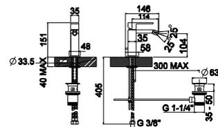
**1** Хромированный однорычажный смеситель для биде с керамическим картриджем Ø25 мм. Связь 3/8", длина шлангов 405-мм, с автоматическим клапаном слива и аэратор "plus". Пропускная способность при 3 барах 10,5 л/мин.
