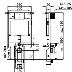
**1A** Двойная встроенная рама с бачком для подвесного унитаза. Установка в тонкую стену с набором креплений и трубой соединения с унитазом.
