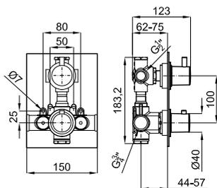
Смеситель с термостатом, скрытого монтажа, на 2 отверстия с элементом покрытия из воска. Связи 1/2" - 3/4" согласно плану. Регулирующий переключатель давления. Пропускная способность при 3 барах - 1 выхода 25,4 л/мин. и другой 22,7 л/мин. Включает обратный клапан и предохранитель на 38°
