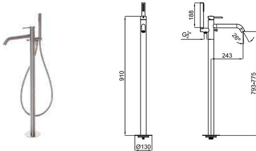
**1** Напольный смеситель для ванны/душа с гибким шлангом 150 см и ручным душем. Керамический картридж Ø35 мм, автоматический переключатель и аэратор "plus". Пропускная способность при 3 бар: душ 11,83 л/мин., ванна: 16,64 л/мин. Необходим встроенный корпус Smart box для напольного смесителя 100149141.
