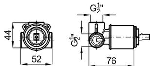
PROJECT LINE - Внутренняя часть встроенного смесителя для душа с керамическим картриджем 35мм и подключениями 1/2". Пропускная способность при 3х барах со смешанной водой 21л/мин **100107937** **25,00 €**
