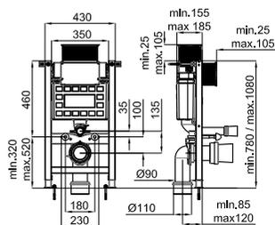
Каркас подвесного унитаза с бачком, укороченный, с подводом сверху или сбоку. Включает комплект для крепления на стену и трубки для соединения с унитазом.
