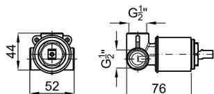
PROJECT LINE - Внутренняя часть встроенного смесителя для душа с керамическим картриджем 35мм и подключениями 1/2". Пропускная способность при 3х барах со смешанной водой 21л/мин **100107937**
