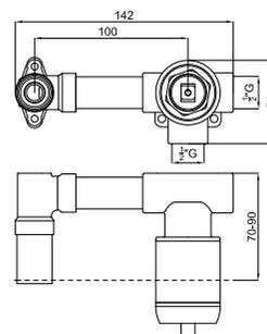
**1A** Наружная часть однорычажного смесителя для раковины скрытого монтажа с ребристой ручкой и круглым изливом. Пропускная способность при 3 барах 5,68 л/мин
