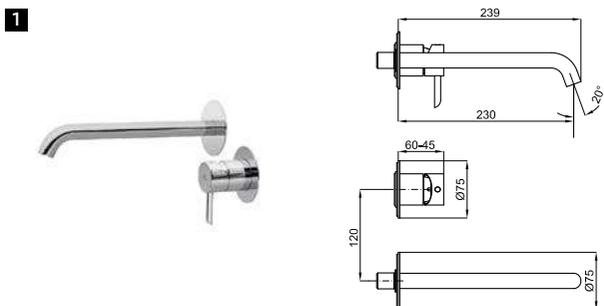
**1** Наружная часть встроенного смесителя для раковины. Без донного клапана. Напор при 3-х атмосферах 5 Л/мин
