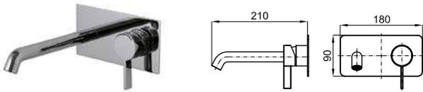
1 Внешняя часть, встроенного смесителя для раковины с керамическим картриджем 35мм. Без донного клапана. Пропускная способность воды при 3 барах - 5 л/мин. Возможность горизонтального и вертикального монтажа.
