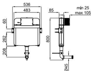
Бачок Универсальный встроенный для унитаза независимого. Установка в твердую стену, с набором настенных креплений и трубой соединения с унитазом.
