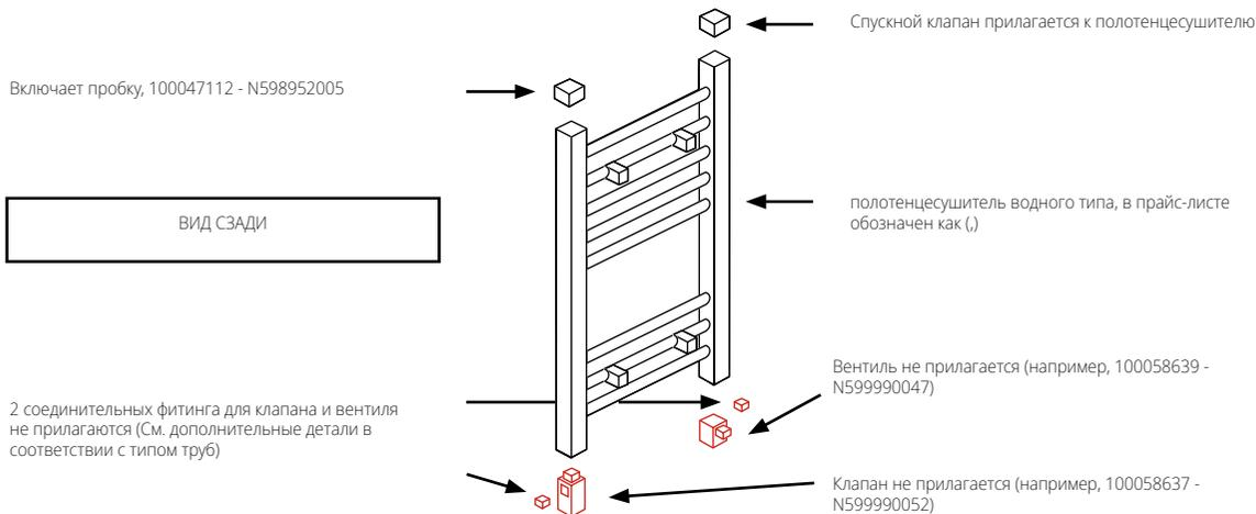
Кран Маевского и крепление в стену, включены в комплект с водяным радиатором. Соединительные фитинги, клапана для вертикальной и горизонтальной однотрубной системы для водяных радиаторов, всегда в хроме, как и заглушка на полдюйма 1/2". Код артикула клапана и вентиля, относится хромированной отделке.
