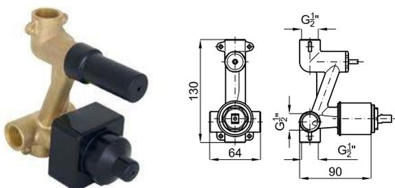
PROJECT LINE - Внутренняя часть встроенного смесителя для ванны/душа с керамическим картриджем 35мм автоматическим инвертором и подключениями 1/2". Пропускная способность при 3х барах со смешанной водой: ванная 20л/мин и душ 18л/мин. **100107958**
