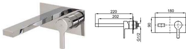
1 Внешняя часть, встроенного смесителя для раковины с керамическим картриджем 35мм. Без донного клапана. Пропускная способность воды при 3 барах - 5 л/мин. Возможность горизонтального и вертикального монтажа.
