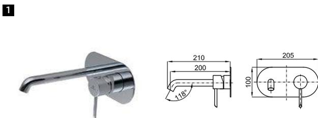
**1** Внешняя часть, встроенного смесителя для раковины с керамическим картриджем 35мм. Без донного клапана. Пропускная способность воды при 3 барах - 5 л/мин. Возможность горизонтального и вертикального монтажа.
