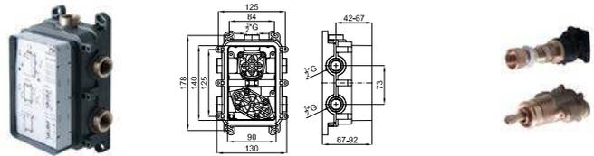
2 SMART BOX SLIM- Универсальный встроенный корпус быстрой установки для термостатических смесителя с 1, 2 или 3 выходами. С восковым термозлементом и подключением 1/2". Давление в 3 бара за 1 выход 22,4 л/мин. и для других 2 выхода 19,5 л/мин.
