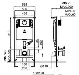
1 I-COMFORT LINE Панель смыва с одной кнопкой и ИК-разрядная система для рамы с системой удаления запаха.
