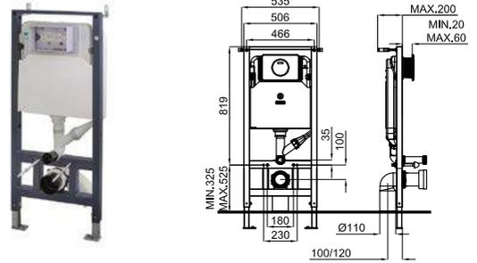
2 Рама + Универсальный встроенный бачок для подвесного унитаза, с системой удаления запаха. Установка в тонкую стену с набором креплений и трубой соединения с унитазом.
