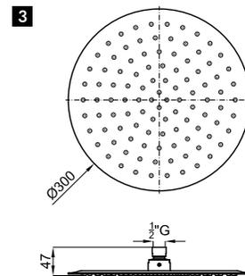
**1** Верхний душ Round 40 см, с шаровым соединением. Пропускная способность при 3 барах 12,4 л/мин
