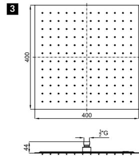
**1** SQUARE. Верхний душ 20 см., с шаровым соединением и защитным клапаном. Пропускная способность при 3 барах 9 л/мин.
