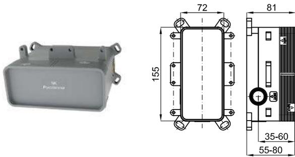
Корпус SMART BOX BATH для установки смесителя для раковины. Керамический картридж Ø35мм и соединения 1/2". Возможность установки в горизонтальном и вертикальном положении.
