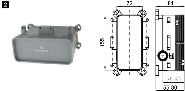
**2** Корпус SMART BOX BATH для установки смесителя для раковины. Керамический картридж Ø35мм и соединения 1/2". Возможность установки в горизонтальном и вертикальном положении.
