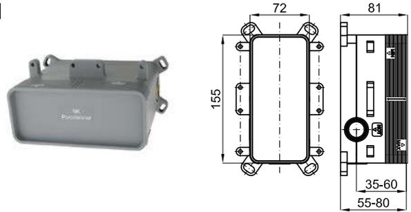
2 Корпус SMART BOX BATH для установки смесителя для раковины. Керамический картридж Ø35мм и соединения 1/2". Возможность установки в горизонтальном и вертикальном положении.
