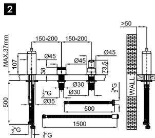
**1** PROJECT LINE - Внутренний корпус смесителя, установка на ванне. Керамический картридж Noken Tri-Control Ø40 мм со встроенным переключателем.
