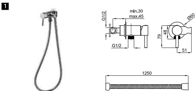
**1** Наружные части однорычажного смесителя для гигиенического душа. В комплект входит гибкий шланг 125мм в металлической обмотке, подвод воды и держатель.
