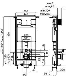
Инсталляция и бачок скрытого монтажа для подвесного унитаза с подготовкой для установки электронного сиденья. Установка в тонкую стену. В комплект входит комплекты крепежа для унитаза и подключения сиденья.
