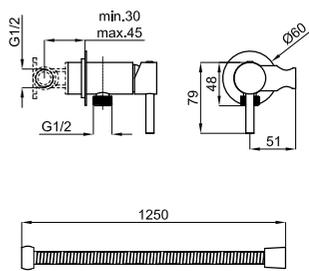
**1** Наружные части однорычажного смесителя для гигиенического душа. В комплект входит гибкий шланг 125мм в металлической обмотке, подвод воды и держатель.
