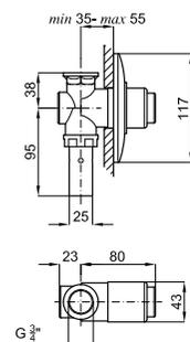
1 Настенная кнопка смыва скрытого монтажа для унитаза, установка в капитальную стену. Рекомендуется установка с трубой 100229695
