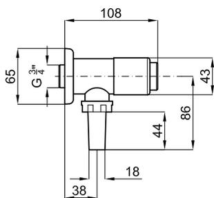
1 Кнопка смыва наружного монтажа с таймером
