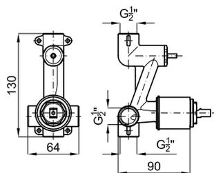
PROJECT LINE - Внутренняя часть встроенного смесителя для ванны/душа с керамическим картриджем 35мм автоматическим инвертором и подключениями 1/2". Пропускная способность при 3х барах со смешанной водой: ванная 20л/мин и душ 18л/мин. **100107958** **67,00 €**
